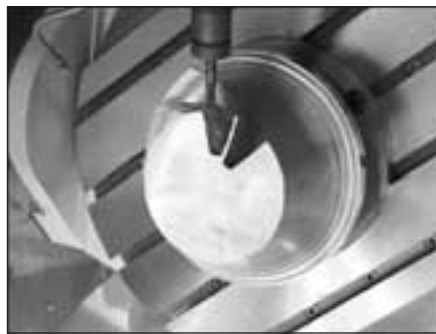
図3：同時5軸制御加工例
