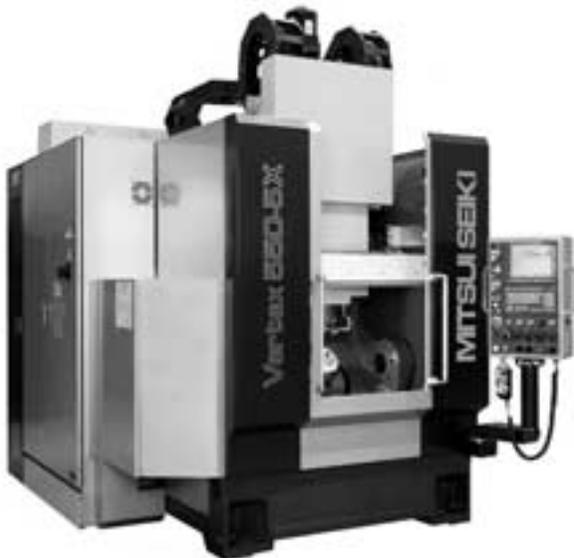
は仕方のないことでした。それは傾斜・回転テーブルがX軸またはY軸上に載っていたからです。ところがVertexはわずか2m×3mのスペースで500mmのワークを載せることが可能です。キューブオン構造+ベッドの側壁を利用して傾斜駆動機構を組み込むことによってこれが可能になりました。
