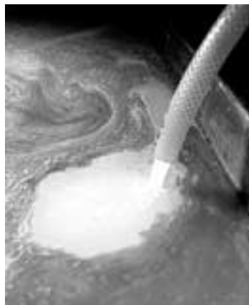
写真-2 汚れた表面のクーラント液を吸い込みクリーニング後にタンクに戻す。
