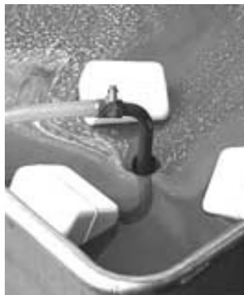
写真-2 汚れた表面のクーラント液を吸い込みクリーニング後にタンクに戻す。
