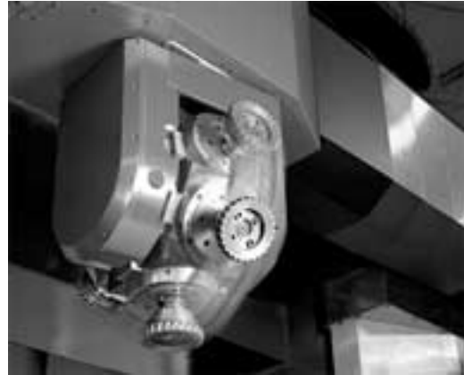
図-3：多面割り出し5軸ヘッドの旋回
