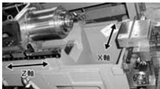
写真3. X軸、Y軸配置
