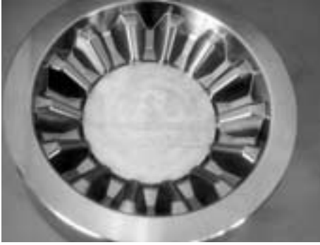
写真4 高硬度材ベベルギア
