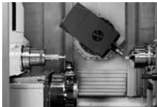
工具主軸 R側ミーリング加工 / 下刃物台 L側旋削加工
