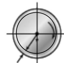
クリアランスが1mm以下の場合にハイドロスタティック効果が発生します。ただし、バー径と形状に依存します。
