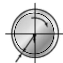
主軸回転速度がおおよそ500~700rpm超でハイドロダイナミクス効果が発生します。ただし、バー径と形状に依存します。
