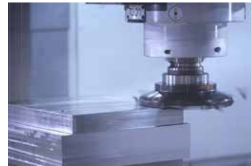
図6: 重切削加工の様子
