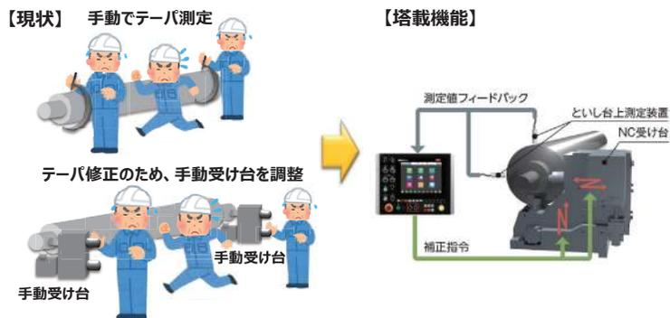
図5：NC 受け台によるロール部テーパ修正
