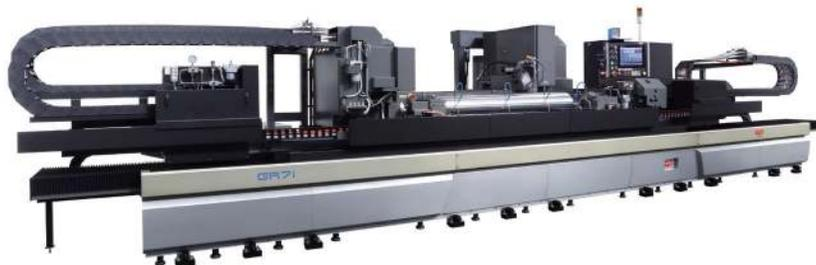
高精度ロール研削盤：GR7i-400
