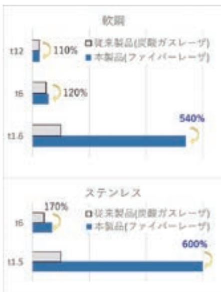
図4：各種材料、板厚の加工速度比較
