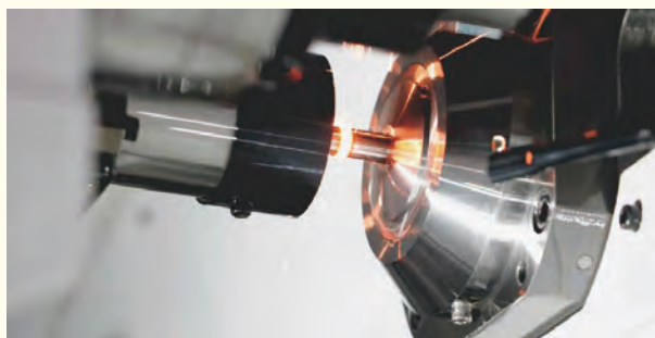
残材と新材を摩擦接合で接合する
