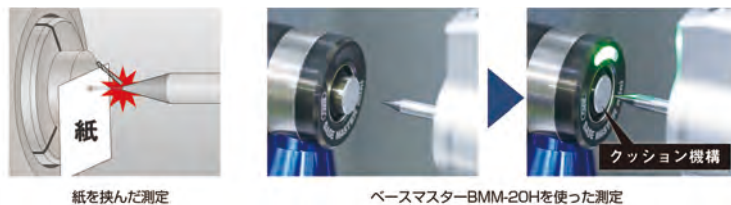
図3 従来とベースマスターを使った測定方法の比較
