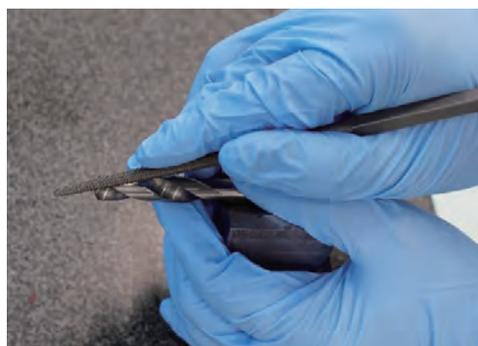
写真5：手作業によるホーニング加工
