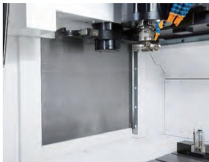
図2：電動 ATC シャッタ
