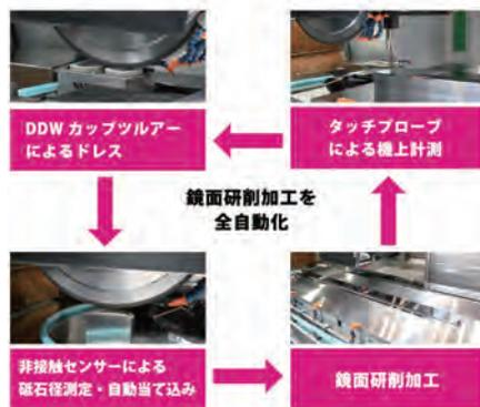
図2：全自動鏡面研削加工の概要
