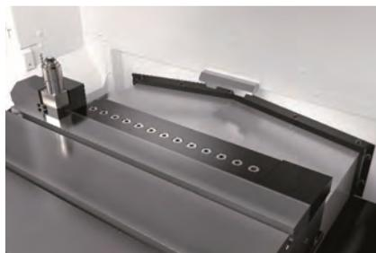
図6：テーブル後方の治具配管ポート
