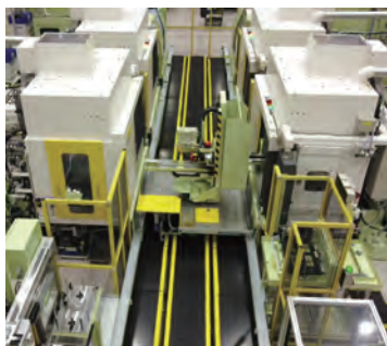
二段型スライドローダー、 様々な設備のセットアップ
