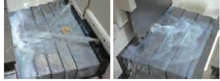
写真 2：機内洗浄の様子
