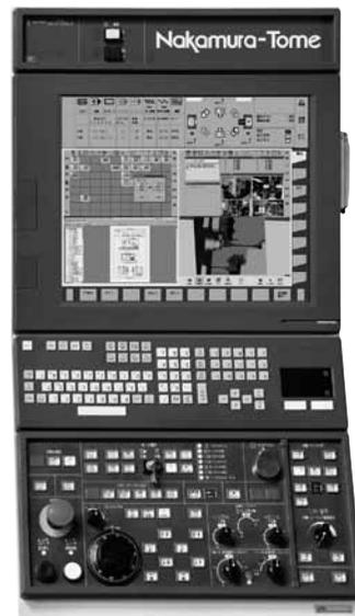
19インチ、カラー液晶タッチパネル搭載した新型制御盤
