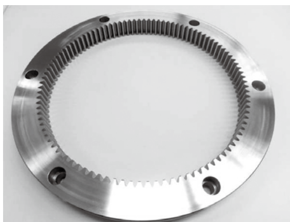
図11 スムースギアスカイピングにより加工した内歯車（モジュール3、歯数102枚、材質S45C、歯先円直径300mm）
