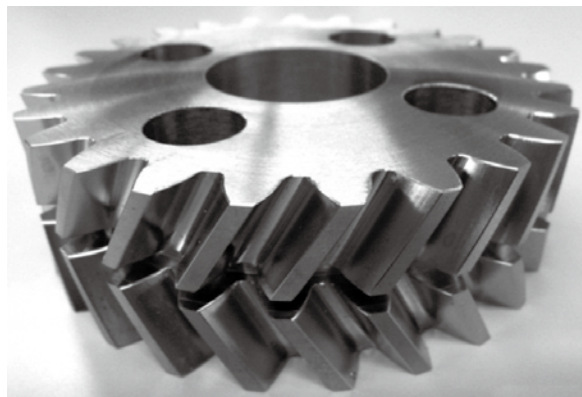
図6 スムースギアミリングにより加工したダブルヘリカルギア
