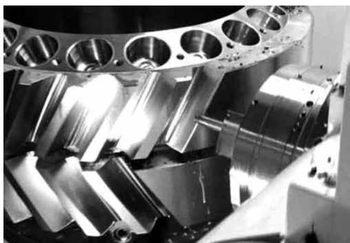
図3 スムースギアミリングによる歯車加工
