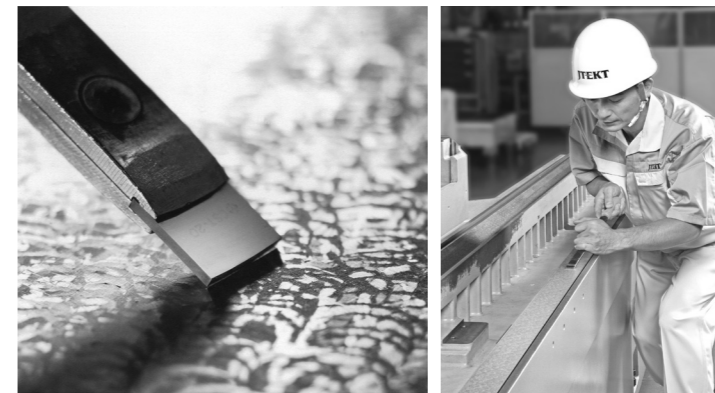
写真2：熟練作業によるきさげ加工
