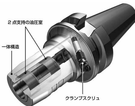
図3.ハイドロチャックの構造
