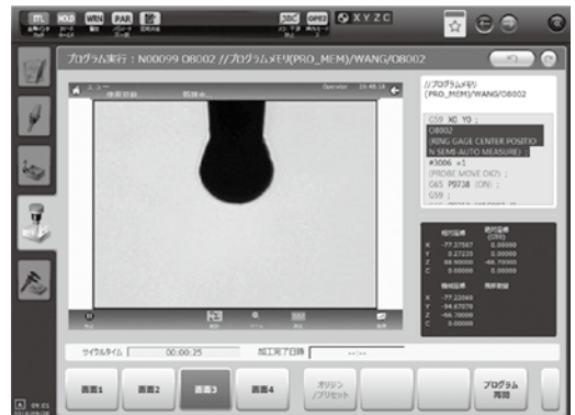
図4: 工具形状測定装置とプロフェッショナル6画面
