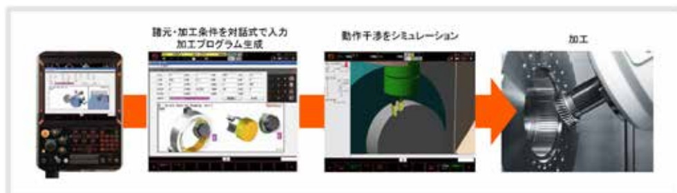
歯車の加工および計測のプログラミング支援機能
