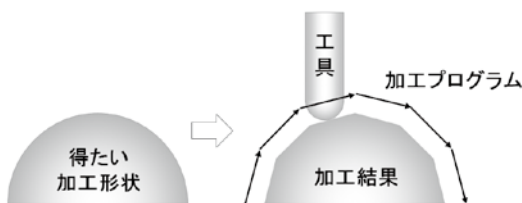
図3. 加工形状と加工プログラム
