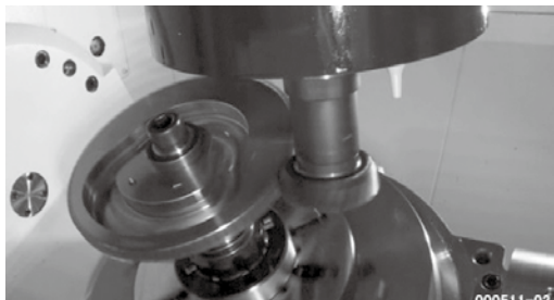
図4. パワースカイピング工法によるギヤ加工
