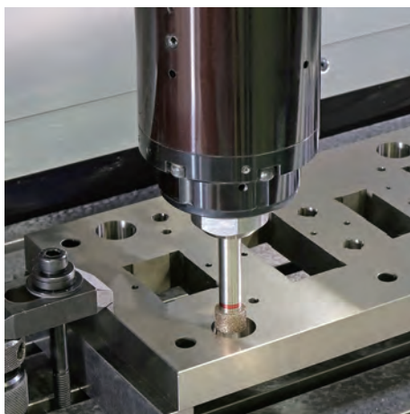
図1・写真2：遊星回転による穴加工
