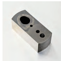
写真1：缶の上蓋とステイオンタブ金型
